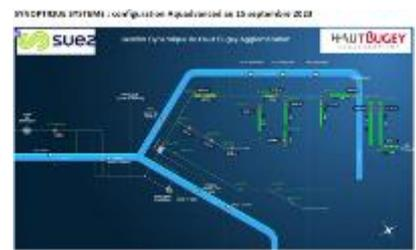
A l'aide de capteurs installés au niveau des vannes, l'exploitant pourra piloter le fonctionnement et veiller à la fois à l'atteinte de la conformité et à l'absence de débordements. Cette opération d'un coût de 1 million d'euros hors taxe sera mise intégralement en service en janvier 2024.
